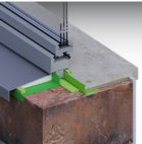
Verarbeitung des Fensteranschlusses mit FM230.
